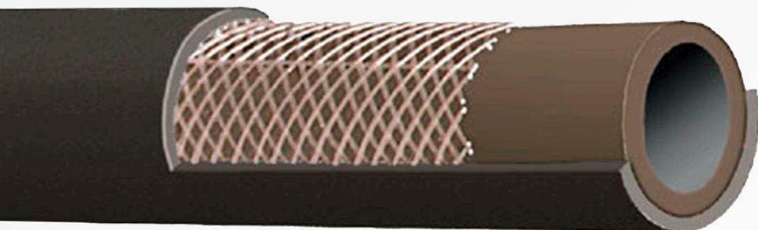
**Construcción:** Tubo de caucho SBR / NBR, reforzado con un trenzado de poliéster. Cubierta de caucho sintético resistente a la abrasión y a la intemperie.
